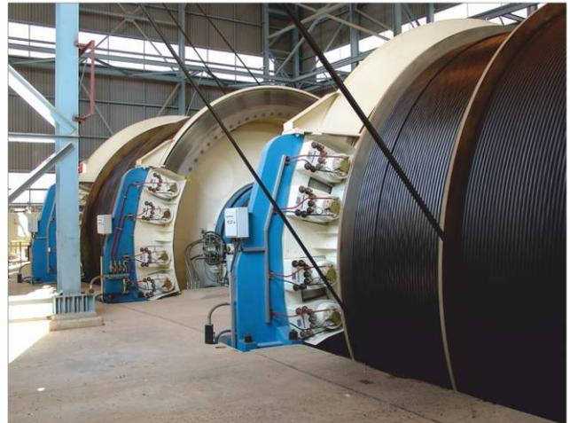
Soudobý elektrický bubnový těžní stroj s drátěnými lany.
