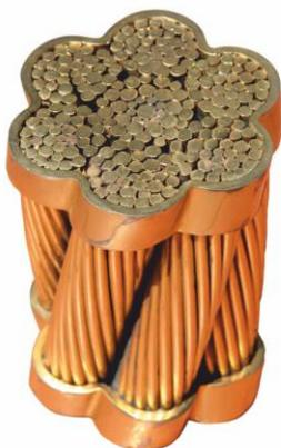
Vzorek závěsného drátěného lana z mostu Golden Gate Bridge v San Francisco v USA.
