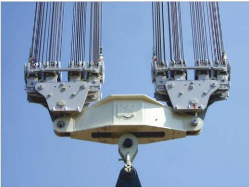
Kladka jeřábu s drátěnými lany TEREX.
